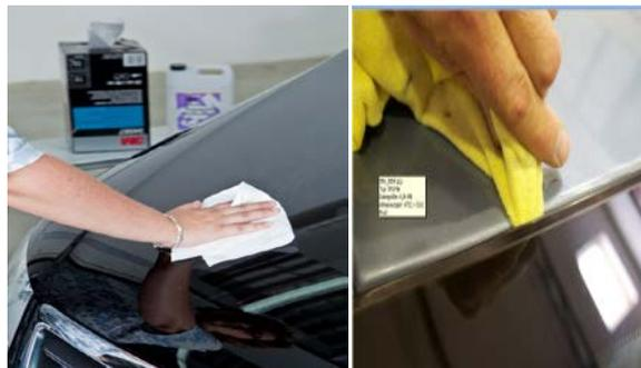
Reinigung von Flächen und kritischen Stellen, z.B. unter Gummidichtungen
