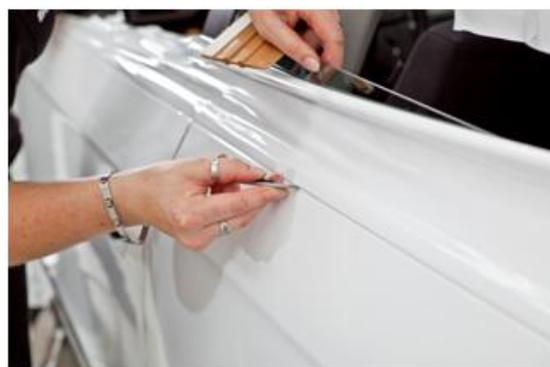
An weicher Gummileiste wird die Folie mit einem Überstand von 2 Millimetern weggeschnitten und danach unter die Gummidichtung gerakelt. Der Einsatz von Knifeless Tape wird empfohlen.
