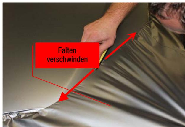
Wichtig ist, dass Sie darauf achten, beim Einsatz von Wärme niemals die noch erhitze Folie zu rakeln, da dieses zu irreparablen Folienschäden führt. Um Klebstofflinien zu vermeiden, lassen Sie erwärmte Stellen immer einige Sekunden abkühlen, bevor Sie die Rakel ansetzen. Legen Sie dann die Folie stressfrei auf die zu beklebende Stelle auf. Keine Dehnung in die Folie geben, da sie sonst vor allem im Kantenbereich eine Rückschrumpfung zeigt (Sägezahneffekt)!
