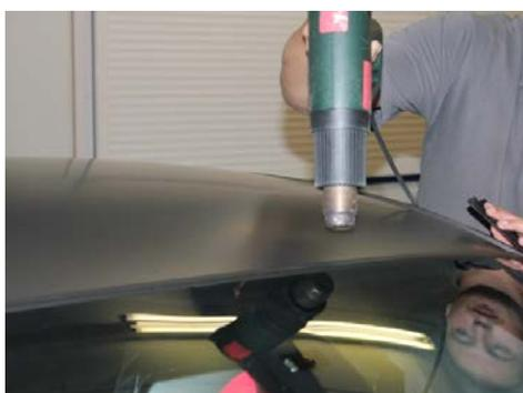
Carbon-Look und BR gebürstete Versionen können aufgrund der Struktur der Folienoberfläche in gedehnten Bereichen bei höherer Temperatur leichter einreißen und werden daher mit +40°C bis +50°C nachgeföhnt.
